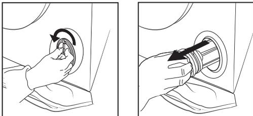
8. Abpumpfilter reinigen: Entfernen Sie Rückstände aus dem Filter und reinigen Sie ihn unter fließendem Wasser.
