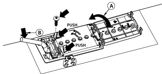
**Apparaten måste vara kopplad till elnätet genom en allpolig säkerhetsbrytare med ett kontaktavstånd på minst 3 mm.**
