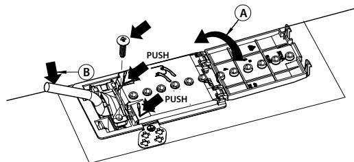
**Het apparaat moet worden aangesloten op het elektriciteitsnet via een meerpolige tussenschakelaar met een afstand van minstens 3 mm tussen de contacten.**
