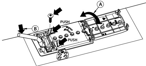
**Il collegamento alla rete elettrica deve essere effettuato tramite un sezionatore onnipolare avente una distanza minima fra i contatti di 3 mm.**
