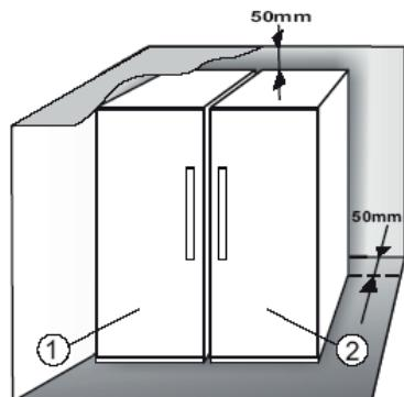
Recomendamos que a instalação dos dois aparelhos em conjunto seja realizada utilizando o kit de ligação ③ (conforme apresentado na figura). Este pode ser adquirido junto da Assistência.
