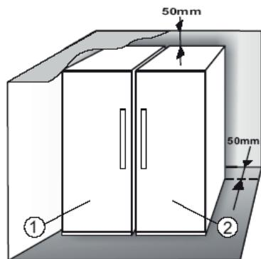
Se recomienda instalar dos aparatos juntos usando el kit de unión ③ (tal como muestra el dibujo).
