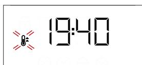
Σημείωση: Κατά τη διάρκεια ψησίματος μπορείτε να αλλάξετε λειτουργία γυρίζοντας το κουμπί επιλογής ή να ρυθμίσετε τη θερμοκρασία γυρίζοντας τον επιλογέα θερμοστάτη. Η λειτουργία θα ξεκινήσει μόνο αν ο επιλογέας θερμοστάτη βρίσκεται σε 0 °C. Μπορείτε να ρυθμίσετε το χρόνο ψησίματος, το χρόνο τέλους ψησίματος (μόνο εάν ρυθμίσετε το χρόνο ψησίματος) και το χρονοδιακόπτη.
