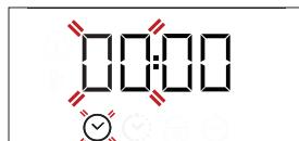
Uporabite + ali - za nastavitev ure in pritisnite 0 za potrditev. Števki za minute začneta utripati. Uporabite + ali - za nastavitev minut in pritisnite 0 za potrditev.
