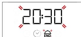
Χρησιμοποιήστε το ή το για να ρυθμίσετε την ώρα που θέλετε να τελειώσει το μαγείρεμα και πιέστε το για επιβεβαίωση. Ενεργοποιήστε τη λειτουργία στρέφοντας τον επιλογέα θερμοστάτη στην επιθυμητή θερμοκρασία: Η λειτουργία θα παραμείνει σε αναμονή έως ότου ξεκινήσει αυτόματα μετά από το χρονικό διάστημα που υπολογίστηκε προκειμένου να τερματιστεί το μαγείρεμα στο χρόνο που επιλέξατε.
