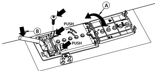
**Uredaj priključite na električno napajanje pomoću višepolnog prekidača za iskopčavanje s razmakom između kontakata najmanje 3 mm.**
