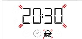
Utilisez ou pour régler la durée de cuisson et appuyez sur pour confirmer. Lancez la fonction en tournant le *bouton du thermostat* à la température désirée : la fonction reste en veille et démarre automatiquement après la période d'attente calculée pour que la cuisson se termine à l'heure désirée.
