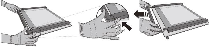
2. Levante e segure firmemente o vidro interior com ambas as mãos, removendo-o e colocando-o sobre uma superfície suave antes de proceder à sua limpeza.
