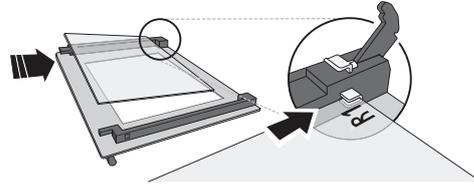
4. Remplacez le bord supérieur : un clique indique qu'elle est bien placée. Assurez-vous que le joint est bien placé avant de replacer la porte.
