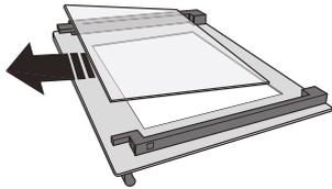
3. Reinstale o painel intermédio (com a marca "1R") antes de instalar o painel interior: Para posicionar os painéis de vidro corretamente, certifique-se de que é possível visualizar a marca "R" no canto esquerdo. Insira primeiro a parte mais longa do vidro com a indicação "R" nos suportes e, em seguida, baixe-a até à posição correta. Repita este procedimento para ambos os painéis de vidro.
