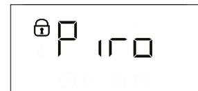
Uma vez concluído o ciclo, a porta permanece trancada até que a temperatura no interior do forno tenha baixado para um nível seguro. Areje a divisão durante e após a execução de um ciclo de limpeza pirolítica.
