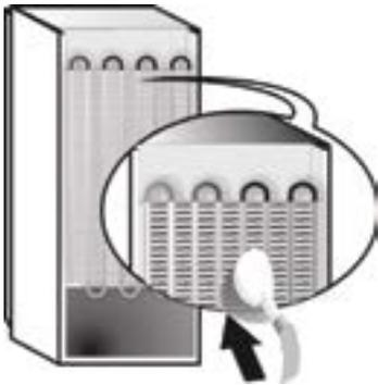
Pour assurer une évacuation constante et correcte de l'eau de dégivrage, nettoyez régulièrement l'intérieur de l'orifice d'évacuation situé sur la paroi arrière du compartiment réfrigérateur, à proximité du bac à fruits et légumes, à l'aide de l'outil fourni avec l'appareil.
