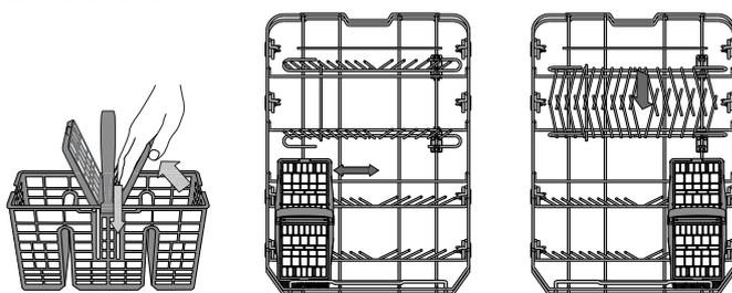
**Cuțitele și alte ustensile cu margini ascuțite trebuie amplasate în coșul pentru tacâmuri cu vârfurile orientate în jos sau poziționate orizontal în compartimentele rabatabile ale raftului superior.**
