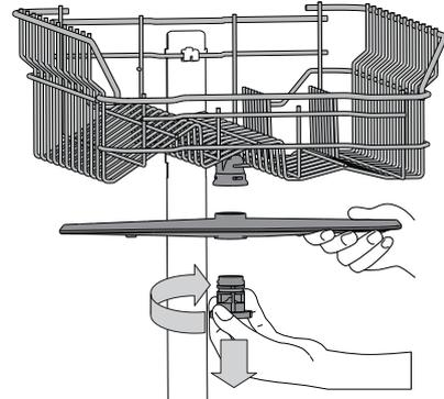
Per smontare il braccio aspersore superiore, ruotare l'anello di bloccaggio in plastica in senso orario. Il rimontaggio del braccio aspersore deve avvenire in modo che il lato con il maggior numero di fori sia rivolto verso l'alto.
