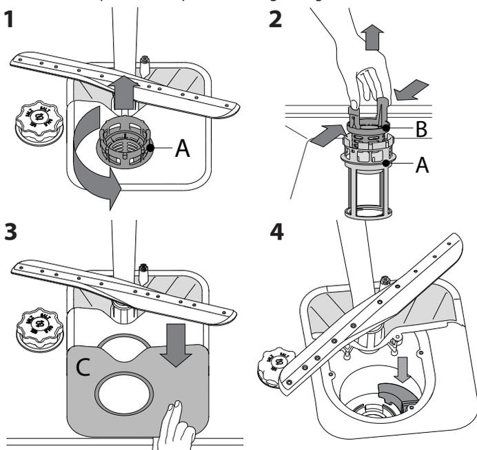
După curățarea filtrelor, montați la loc ansamblul de filtre și fixați-l în poziția corectă; acest lucru este esențial pentru menținerea funcționării eficiente a mașinii de spălat vase.
