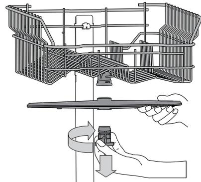
Aby zdjąć górne ramię natryskowe należy przekręcić plastikowy pierścień blokujący w kierunku ruchu wskazówek zegara. Górne ramię natryskowe powinno zostać z powrotem założone w taki sposób, aby strona z większą liczbą otworów była skierowana do góry.
