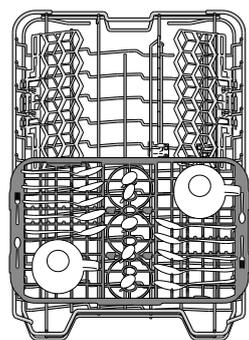
Raftul superior este prevăzut cu o tavă culisantă care poate fi utilizată pentru a depozita vase mici și tacâmuri. Pentru a obține performanțe optime de spălare, evitați poziționarea veselei voluminoase direct sub tavă. Tava este detașabilă.
