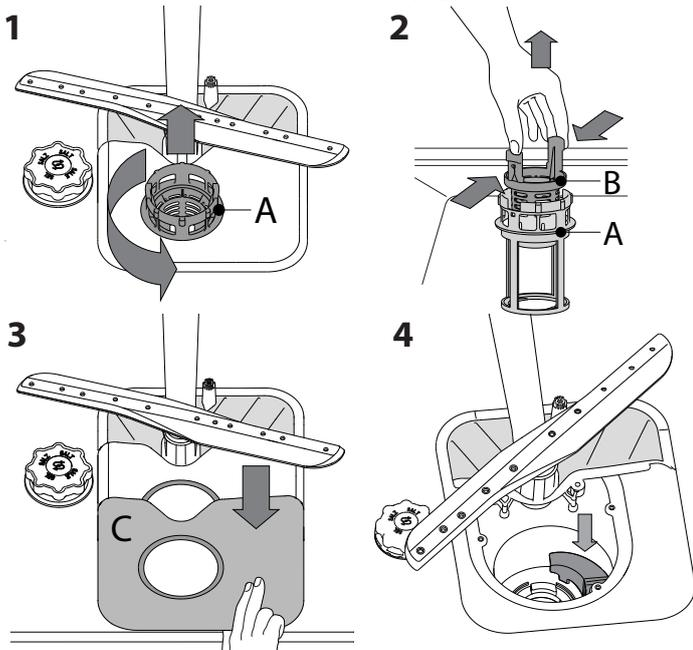
Po oczyszczeniu filtrów założyć z powrotem zespół filtra i zamocować go w prawidłowym położeniu; jest to niezbędne dla utrzymania sprawnego funkcjonowania zmywarki.
