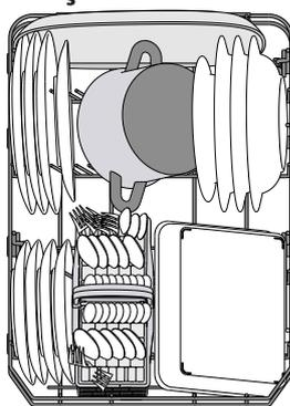
Pentru oale, capace, farfurii, boluri pentru salată, tacâmuri etc. În mod ideal, farfuriile și capacele mari trebuie amplasate în părțile laterale, pentru a se evita interferențele cu brațul de pulverizare.
