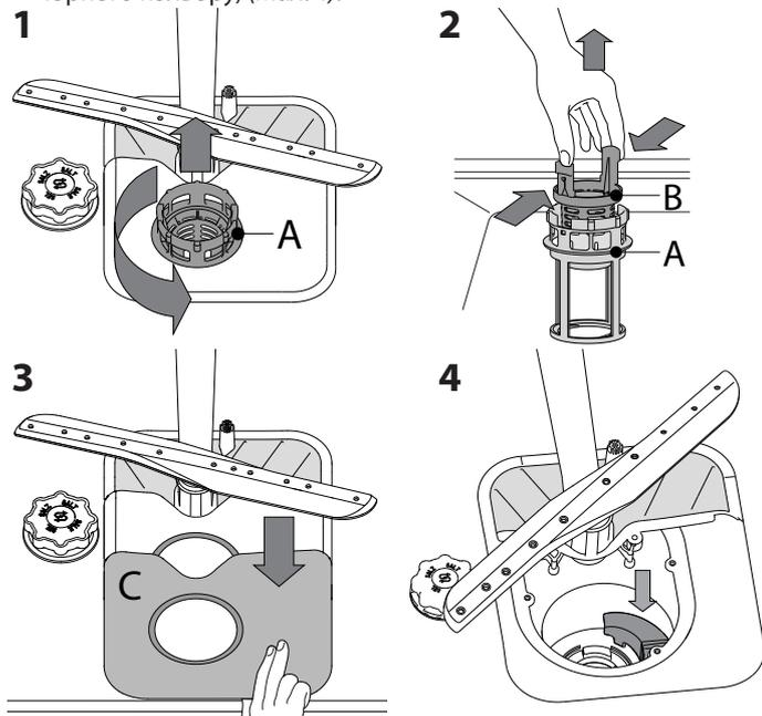
Після очищення фільтрів встановіть вузол фільтра на місце та закріпіть його у цьому положенні належним чином; це дуже важливо для ефективного функціонування посудомийної машини.
