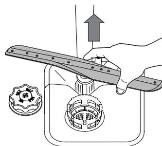
Brațul de pulverizare inferior poate fi demontat prin tragerea în sus.
