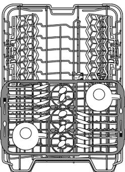
Górny kosz jest wyposażony w przesuwającą tackę, która może być używana do umieszczania małych naczyń i sztućców. W celu uzyskania optymalnych efektów zmywania należy unikać umieszczania dużych naczyń bezpośrednio poniżej tej tacki. Tackę można wyjmować.
