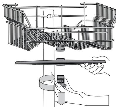
Pentru a demonta brațul de pulverizare superior, rotiți inelul de fixare din plastic în sens orar. Brațul de pulverizare superior trebuie introdus astfel încât partea cu cele mai multe orificii să fie îndreptată în sus.
