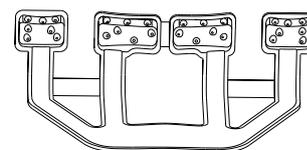
nella parte posteriore del cestello e utilizzabile per sostenere in posizione verticale pentole e casseruole e ottimizzare in tal modo lo spazio.
