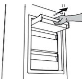
2. Maak het STOP FROST-accessoire los en verwijder het, let erop dat u het niet op de glasplaat eronder laat vallen.
