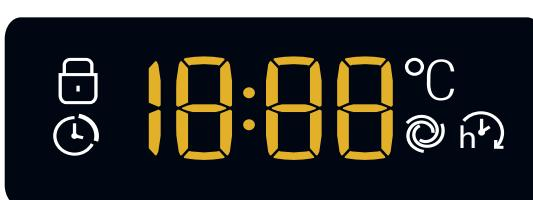
Se visualiza la duración de los diferentes programas a disposición y una vez que comienza el ciclo, el tiempo residual hasta la finalización (la pantalla muestra la duración máxima del ciclo seleccionado, que puede disminuir después de unos minutos, ya que la duración efectiva del
