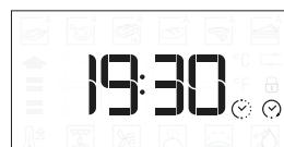
Veuillez noter : La programmation d'un délai pour le début de la cuisson désactive la phase de préchauffage. Le four va atteindre la température désirée graduellement, ce qui signifie que les temps de cuisson vont être légèrement plus longs que ceux indiqués sur le tableau de cuisson.
