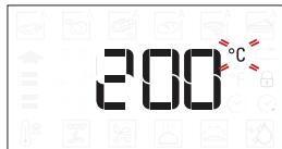
Коли на дисплеї миготітиме значок  $^{\circ}\text{C}/^{\circ}\text{F}$ , змініть значення обертанням перемикача, підтвердить за допомогою
