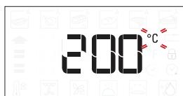
Când pictograma  $^{\circ}\text{C}/^{\circ}\text{F}$  clipește pe afișaj, rotiți butonul pentru modificarea valorii, apoi apăsați
