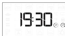
Nota: programmare l'avvio ritardato di una cottura, disattiva in ogni caso la fase di preriscaldamento del forno: la temperatura desiderata viene raggiunta gradualmente, quindi i tempi di cottura si allungheranno leggermente rispetto a quanto indicato nella tabella di cottura.
