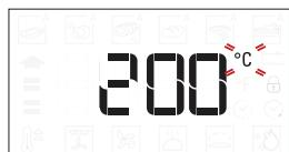
Kui ekraanil vilgub ikoon  $^{\circ}\text{C}/^{\circ}\text{F}$ , keerake väärustuse muutmiseks nuppu, ja seejärel vajutage kinnitamiseks . Pärast seda muutke järgnevaid seadeid (kui on võimalik).
