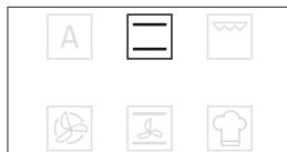
Jei norite pasirinkti papildomą funkciją (kai tai įmanoma), pasirinkite pagrindinę funkciją ir paspauskite , kad patvirtintumėte ir pereitumėte į funkcijos meniu.
