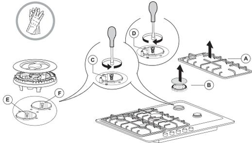
Antes de instalar a placa, não se esqueça de afixar a placa de calibração do gás fornecida com os injectores, de forma que esta cubra a informação anterior relativa à calibração de gás.
