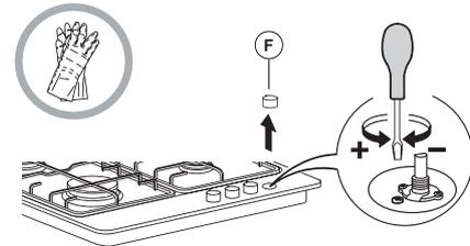
Quando terminar o ajuste, torne a selar usando cera ou um material equivalente.
