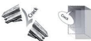
El so CLIC és del termostat que ajusta la freqüència de funcionament del compressor.
