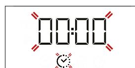
Upotrijebite ili za postavljanje potrebnog vremena pečenja i pritisnite za potvrdu. Funkciju uključite okretanjem *gumba termostata* na potrebnu temperaturu: Oglasit će se zvučni signal i na zaslonu će se označiti da je pečenje završeno.
