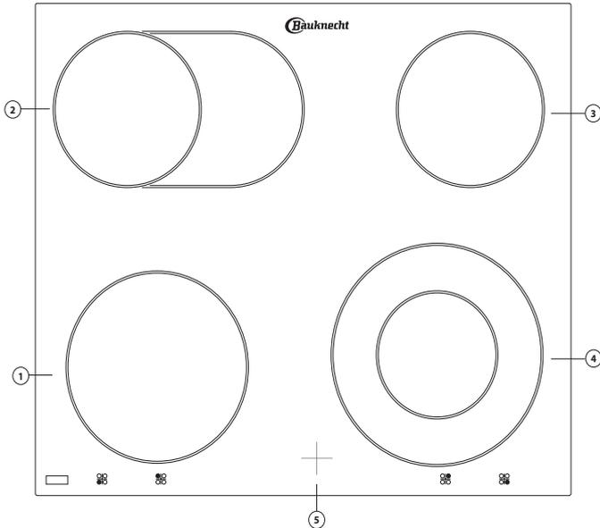
1. Zona di cottura radiante Ø 180
