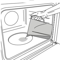
A forno freddo, riempire la cavità sul fondo del forno con la quantità d'acqua potabile indicata nella tabella di cottura. Introdurre la pietanza nel forno.
