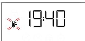
Remarque : Lors de la cuisson, vous pouvez changer la fonction en tournant le *bouton de sélection* ou ajuster la température en tournant le *bouton du thermostat*. La fonction ne démarre pas tant que le *bouton du thermostat* est sur 0. Vous pouvez régler le temps de cuisson, le temps de fin de cuisson (seulement si vous réglez le temps de cuisson) et la minuterie.
