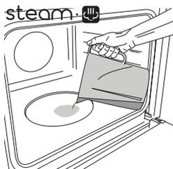
Une fois que le four est froid seulement, remplissez le gaufage de la cavité avec la quantité d'eau potable suggérée dans le tableau de cuisson correspondant. Enfourez le plat.
