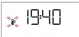
Veillez noter : Lors de la cuisson, vous pouvez changer la fonction en tournant le *bouton de sélection* ou ajuster la température en tournant le *bouton du thermostat*. La fonction ne démarre pas tant que le *bouton du thermostat* est sur 0. Vous pouvez régler le temps de cuisson, le temps de fin de cuisson (seulement si vous réglez le temps de cuisson) et la minuterie.
