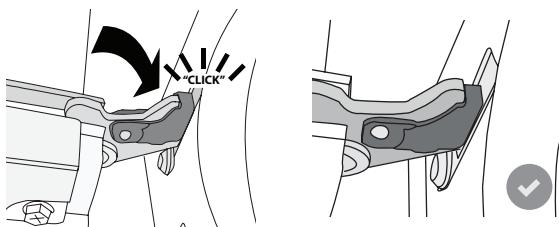
**5.** Prøv at lukke lågen og kontrollér at den står på linje med betjeningspanelet. Gentag i modsat fald de ovenstående trin: Lågen kan tage skade, hvis den ikke virker som den skal.
