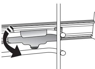
Varmista ohjain paikalleen painamalla pidikkeen alaosaa tiukasti hyllykköohjainta vasten. Varmista, että liukukappaleet liikkuvat vapaasti. Toista nämä vaiheet toiselle samalla tasolla olevalle kannattimelle.
