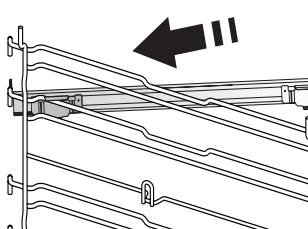
Z trouby odstraňte boční vodicí mřížky a z posuvných drážek ochranné fólie.
