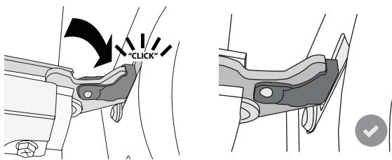
**5.** Yritä sulkea luukku ja varmista, että se on tasassa käyttöpaneelin kanssa. Jos näin ei ole, toista yllä olevat vaiheet: Jos luukku ei toimi oikein, se saattaa vahingoittua.
