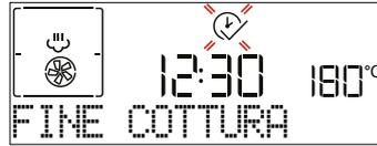
Ruotare la *manopola di regolazione* per impostare l'ora di fine cottura desiderata, quindi premere  per confermarla e attivare la funzione. Inserire il cibo nel forno e chiudere la porta: la funzione si avvierà automaticamente dopo un periodo di tempo calcolato per terminare la cottura all'orario impostato.
