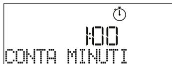
Dopo avere attivato il conta minuti, è anche possibile selezionare e attivare una funzione. Ruotare la *manopola di selezione* per accendere il forno selezionando la funzione desiderata.
