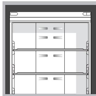
No Frost zagotavlja nepreklenjen dotok hladnega zraka, ki pobira vlago in preprečuje nastajanje ledu in ivja: v hladilniku vzdržuje pravilni nivo vlažnosti in, ker ni ivja, živila ohranijo svojo prvotno kakovost; v zamrzovalniku preprečuje nastajanje ledu, zaradi česar odtajevanje ni potrebno, in preprečuje sprijemanje živil.
