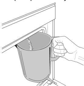
Nachdem die Funktion „Abpumpen“ ausgewählt wurde, drücken Sie **▷** und befolgen die angegebenen Maßnahmen: Die Tür öffnen und eine große Kanne unter die Abpumpdüse rechts unter dem Bedienfeld positionieren. Nachdem das Abpumpen gestartet wurden, den Krug in dieser Position halten, bis der Vorgang beendet ist. Die
