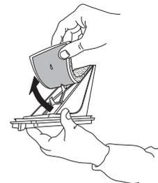
Fixez la mousse de filtre sur le filtre inférieur. Nettoyez la chambre du filtre de la sècheuse avec un chiffon humide ou minutieusement avec un aspirateur. Réinsérez le filtre inférieur. Refermez la poignée de filtre et fermez le volet inférieur.
