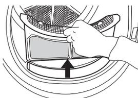
Appuyez sur le bouton pour ouvrir le filtre de porte. Enlevez les peluches à l'intérieur. Fermez le filtre et réinsérez-le dans la bonne direction, de sorte qu'il soit totalement intégré dans la chambre du filtre.
