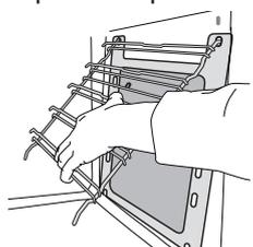
Para sacar el máximo partido a las propiedades de autolimpieza de los paneles catalíticos, recomendamos que caliente el horno a 200 °C durante aproximadamente una hora. Durante este tiempo, el horno debe permanecer vacío. Deje el horno abierto para que se enfríe antes de eliminar los residuos de alimentos con una esponja no abrasiva.
