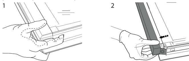
Sollevarlo e prendere saldamente il vetro interno con due mani, rimuoverlo e appoggiarlo su un piano morbido prima di eseguire la pulizia.
