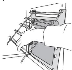
Questi pannelli sono montati sulle griglie laterali: quando queste vengono rimosse, per un corretto posizionamento, assicurarsi che l'aggancio superiore delle griglie sia infilato negli appositi fori dei pannelli.
