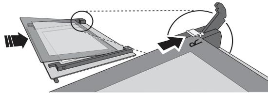
Vuelva a colocar la parte superior: un clic le indicará que se ha colocado correctamente. Asegúrese de que el precinto esté asegurado antes de volver a montar la puerta.
