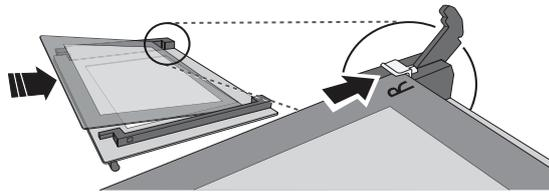
Remplacez le bord supérieur : un déclic indique le positionnement correct. Assurez-vous que le joint est bien placé avant de replacer la porte.
