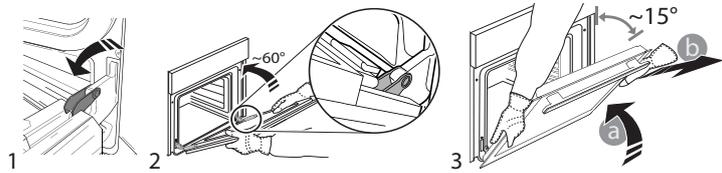
Togliere la porta e appoggiarla su un piano morbido. Per rimontare la porta, avvicinarla al forno allineando i ganci delle cerniere alle proprie sedi e ancorare la parte superiore agli alloggiamenti. Abbassare la porta e poi aprirla completamente. Abbassare i fermi nella posizione originale: fare attenzione che siano completamente abbassati. Provare a chiudere la porta, verificando che sia allineata al pannello di controllo. Se non lo fosse, ripetere tutte le operazioni.
