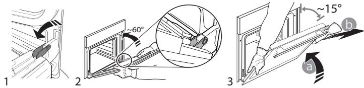
Placez la porte de côté, l'appuyant sur une surface souple. Réinstallez la porte en la plaçant devant le four pour aligner les crochets des charnières avec leurs appuis, et insérez la partie supérieure sur son appui. Abaissez la porte pour ensuite l'ouvrir complètement. Abaissez les loquets dans leur position originale : assurez-vous de les abaisser complètement. Essayez de fermer la porte et assurez-vous qu'elle est alignée avec le panneau de commande. Sinon, répétez les étapes précédentes.
