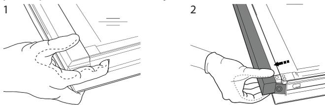
Levante e segure firmemente o vidro interior com ambas as mãos, removendo-o e colocando-o sobre uma superfície suave antes de proceder à sua limpeza.
