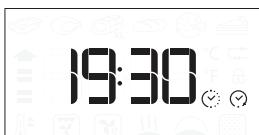
Huomaa: Kypsennyksen viivästetyn käynnistysajan ohjelmoiminen sulkee pois käytöstä uinin esikuumennusvaiheen. Uuni saavuttaa haluamasi lämpötilan vaiheittain, minkä vuoksi kypsennysajat ovat hieman kypsennystaulukossa lueteltuja pitempia.
