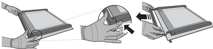
2. Sollevare e prendere saldamente il vetro interno con due mani, rimuoverlo e appoggiarlo su un piano morbido prima di eseguire la pulizia.
