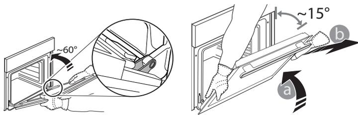
**3.** Per rimontare la porta, avvicinarla al forno allineando i ganci delle cerniere alle proprie sedi e ancorare la parte superiore agli alloggiamenti.
