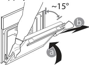
3. Réinstallez la porte en la plaçant devant le four pour aligner les crochets des charnières avec leurs appuis et attacher la partie supérieure sur son appui.
