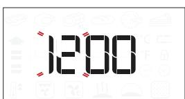
Na displeji začnou blikat dvě číslice nastavení hodin: Pro nastavení hodin otáčejte ovladačem a stisknutím volbu potvrďte.
