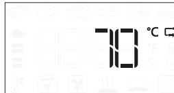
Ha a hűsszondát egy funkció kiválasztása közben csatlakoztatja, a kijelző átvált az alapértelmezett hűsszonda célhőmérsékletre.
