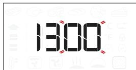
A kijelzőn villogni kezd a percet jelző két számjegy. A perc beállításához forgassa el a beállítógombot, majd hagyja jóvá az gombbal.
