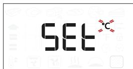
Forgassa el a választógombot a mértékegység
