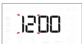
Začnú blikať číslice označujúce hodiny. Otáčaním ovládača nastavte hodinu a potvrdte stlačením .
