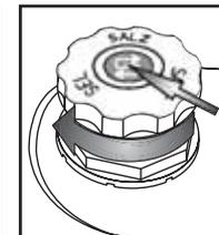
Aperte a tampa. Os resíduos de sal a volta da tampa devem ser removidos. Alguns depósitos de sal têm um indicador de nível integrado na tampa (veja abaixo como verificar).
