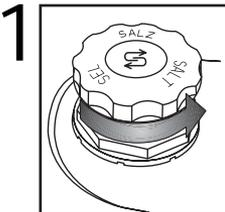
Indicador visual (conforme o modelo). Desaperte a tampa.
