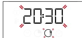
Пісіру аяқталуы тиіс уақытты орнату үшін + немесе – түймелерін пайдаланыңыз және растау үшін ⏳ түймесін басыңыз. Функцияны термостат тетігін қажетті температурага бұрау арқылы іске қосыңыз: функция орнатылған уақытқа сәйкес пісіру үшін есептелген уақыттан кейін автоматты түрде қосылмағанша кідіртілген күйінде қалады.
