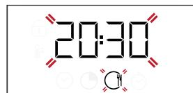
За допомогою кнопки або встановіть бажаний час завершення готовування і натисніть для підтвердження. Активуйте функцію, встановивши ручку **термостата** на бажану температуру: Функцію буде призупинено до її автоматичного запуску після періоду часу, який розраховано так, щоб закінчити приготування у встановлений час.
