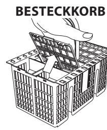
Er ist oben mit Gittern versehen, um das Besteck besser einzurichten. Er darf nur im vorderen Teil des unteren Korbes eingesetzt werden.
