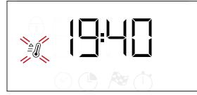
Vă rugăm să rețineți: În timpul procesului de preparare, puteți modifica funcția rotind butonul de selectare sau puteți regla temperatura rotind butonul termostatului. Funcția nu va porni dacă butonul termostatului va fi în poziția **0/AUTO**. Puteți seta durata de preparare, ora de finalizare a procesului de preparare (numai dacă setați o durată de preparare) și un temporizator.
