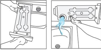
Wenn sich im Trichter des Wassertanks Fasern angesammelt haben, entfernen Sie diese unter fließendem Wasser.
