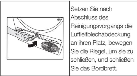
Setzen Sie nach Abschluss des Reinigungsvorgangs die Luftleitblechabdeckung an ihren Platz, bewegen Sie die Riegel, um sie zu schließen, und schließen Sie das Bordbrett.
