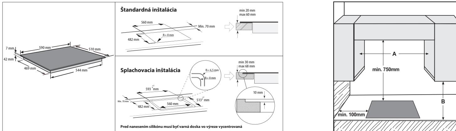
**POZNÁMKA:** ak je vzdialenosť „A“ medzi nástennými skrinkami 600 mm až 730 mm, výška „B“ musí byť minimálne 530 mm.
