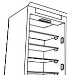
Този уред съдържа 2/4 странични светлинни източника с клас на енергийна ефективност F и горен светлинен източник с клас на енергийна ефективност G
