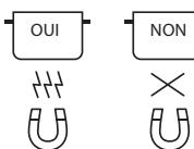
Utiliser uniquement des casseroles et poêles réalisées en matériau ferromagnétique qui sont adaptées à l'utilisation avec des plaques à induction:
