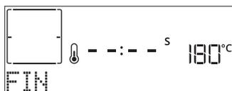
Appuyez sur ▶ pour poursuivre la cuisson en mode manuel (sans minuterie) ou appuyez sur + pour prolonger le temps de cuisson en réglant une nouvelle durée. Dans les deux cas, les paramètres de cuisson seront conservés.
