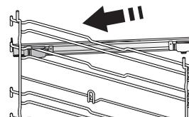
Demontați ghidajele pentru grătar din cuptor și îndepărtați folia protectoare din plastic de pe șinele culisante.
