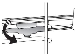
Pentru a fixa ghidajul, apăsați ferm porțiunea inferioară a clemii spre ghidajul pentru grătar. Asigurați-vă că șinele se pot deplasa liber. Repetați acești pași și pentru celălalt ghidaj pentru grătar de la același nivel.
