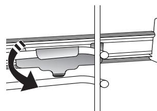
Um die Führungen zu sichern, den unteren Teil des Clips fest gegen das Seitengitter drücken. Sicherstellen, dass sich die Backauszüge frei bewegen können. Diese Schritte am anderen Seitengitter auf der gleichen Einschubebene wiederholen.
