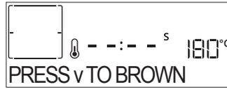
Atunci când pe afișaj apare mesajul aferent, dacă este necesar, apăsați ✓ pentru a porni un ciclu de rumenire de cinci minute. Puteți opri în orice moment funcția apăsând pe ⏻ pentru a opri cuptorul.
