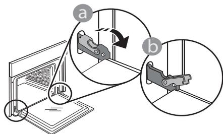
**2.** Feche a porta tanto quanto possível. Segure firmemente a porta com ambas as mãos – não a segure pela pega. Remova, simplesmente, a porta, continuando a fechá-la enquanto a puxa, simultaneamente, para cima, até se libertar do respetivo suporte. Coloque a porta de parte, apoiando-a sobre uma superfície macia.
