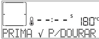
Quando o visor apresentar a mensagem relevante, prima, se necessário, para iniciar um ciclo de tostado de cinco minutos. Pode interromper a função a qualquer altura, premindo para desligar o forno.
