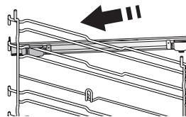
Z trouby odstraňte boční vodicí mřížky a z posuvných drážek ochranné fólie.
