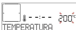
Quando o valor piscar no visor, prima  $+$  ou  $-$  para o alterar e, em seguida, prima  $\checkmark$  para confirmar e continuar com as definições que se seguem (se possível).
