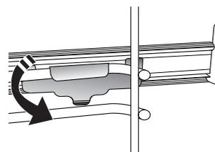
Para fixar a guia, pressione a parte inferior do dispositivo de fixação firmemente contra a guia de nível. Assegure-se de que as corrediças se movem livremente. Repita estes procedimentos para a outra guia de nível, no mesmo nível.
