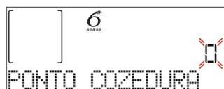
Quando tal lhe for solicitado, prima  $+$  ou  $-$  para selecionar o nível desejado entre mal passado (-1) e bem passado (+1). Prima  $\checkmark$  ou  $\triangleright$  para confirmar e iniciar a função.
