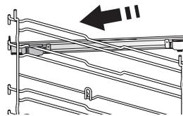
Die Seitengitter aus dem Ofen nehmen und den Kunststoffschutz von den Backauszügen entfernen.
