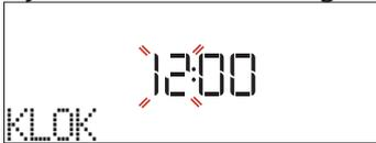
Druk op + of - om het juiste uur in te stellen en druk op ✓ : Op het display knipperen de twee cijfers die de minuten aangeven. Druk op + of - om de minuten in te stellen en druk op ✓ om te bevestigen.
