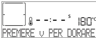
Quando il display visualizza il messaggio pertinente, se necessario, premere per avviare un ciclo di doratura di cinque minuti. Questa funzione può essere interrotta in qualsiasi momento premendo per spegnere il forno.
