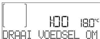
Een hoorbaar signaal gaat af en op het display verschijnt de uit te voeren actie. Open de deur, voer de actie uit die op het display staat, en sluit de deur, druk vervolgens op ▶ om de bereiding voort te zetten.
