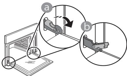
**2.** Închideți ușa cât de mult posibil. Apucați bine ușa cu ambele mâini – nu o țineți de mâner. Demontați pur și simplu ușa, continuând să o închideți și trăgând-o în sus în același timp, până când se eliberează din locaș. Lăsați ușa deoparte, sprijinită pe o suprafață moale.
