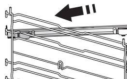
Vyberte vodiace lišty z rúry a z posuvných bežcov odstráňte ochranné plasty. Pripevnite vrchnú svorku bežca na vodiacu lištu a nasuňte, pokiaľ to ide. Druhú svorku spustite na miesto.
