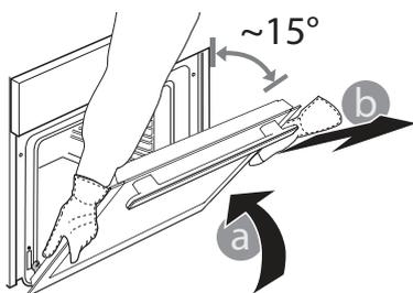
**3.** Reponha a porta, deslocando-a na direção do forno e alinhando os ganchos das dobradiças com os respetivos suportes, fixando a parte superior aos suportes.
