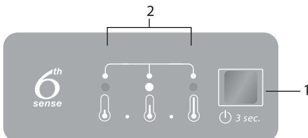
1. Tlačidlo ZAP./POHOT. REŽIM a tlačidlo Teplota
