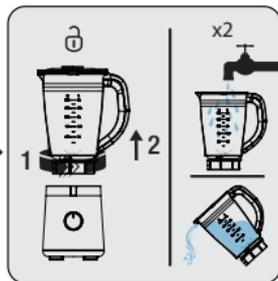
Снимите стеклянный контейнер (3) с блока электродвигателя (6). Промойте его водой, чтобы удалить большие остатки продуктов, которые могут скапливаться в емкости.
