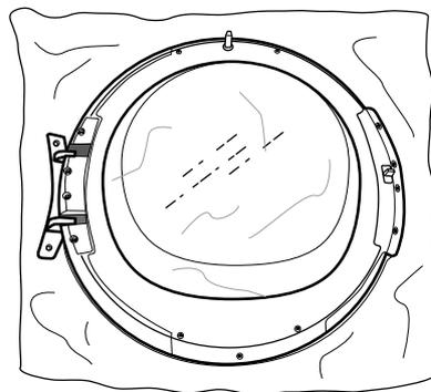
**5.** Desaperte o parafuso superior para libertar a cobertura da estrutura da parte frontal da porta.
