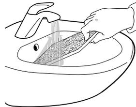
**5.** Torça a espuma do filtro cuidadosamente. Não a insira no filtro inferior a pingar água.
