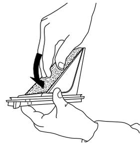
**7.** Limpe a câmara do filtro da máquina de secar com um pano húmido ou utilizando cuidadosamente um aspirador.
