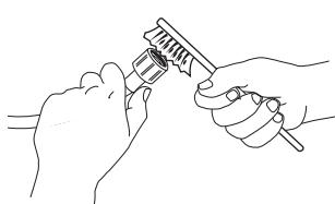
3. Ročno odvijte dovodno cev na zadnji strani pralnega stroja. S kleščami izvlecite mrežni filter iz ventila na zadnji strani pralnega stroja in ga pazljivo očistite.
