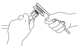
3. Zatim rukom odvijte crevo za dovod vode sa zadnje strane mašine. Kleštimi izvucite mrežasti filter iz ventila sa zadnje strane mašine i pažljivo ga očistite.
