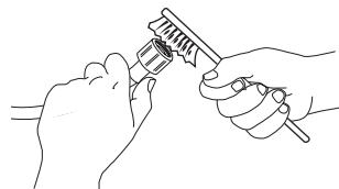
3. Schrauben Sie nun den Zulaufschlauch auf der Rückseite der Waschmaschine mit der Hand ab. Ziehen Sie den Siebfilter mit einer Zange aus dem Ventil auf der Rückseite der Waschmaschine heraus und reinigen Sie ihn vorsichtig.
