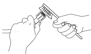
3. Draai nu met de hand de toevoerslang op de achterkant van de wasmachine los. Trek het filter met een tang uit de klep op de achterkant van de wasmachine en maak het zorgvuldig schoon.
