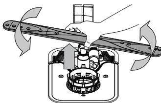
Il braccio di spruzzo inferiore può essere rimosso tirandolo verso l'alto e ruotandolo in senso antiorario. Il montaggio posteriore del braccio di spruzzo avviene tirandolo verso il basso e ruotandolo in senso orario.
