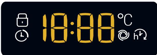
Es werden die Dauer der verschiedenen verfügbaren Programme und bei laufendem Waschgang die bis zu seinem Ende verbleibende Zeit angezeigt (Diese Angabe kann nach einigen Minuten etwas sinken, da die tatsächliche Dauer des Programms von der Wäschemenge und den ausgewählten Einstellungen abhängt); wurde eine STARTZEITVORWAHL eingestellt, dann wird die bis zum Start des ausgewählten Programms verbleibende Zeit angezeigt.
