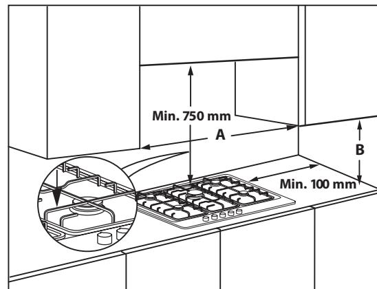
**REMARQUE:** si la distance "A" entre les éléments muraux est de 600mm à 730 mm, la hauteur "B" doit être au minimum de 530mm.
