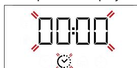
Pomoći + ili - podesite vreme pripreme hrane koje želite, potom pritisnite A da biste potvrdili. Pokrenite funkciju tako što ćete okrenuti dugme termostata na željenu temperaturu: oglasiće se zvučni signal i na ekranu će se prikazati kada je hrana gotova.
