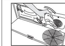
Wenn sich auf der Lüfterabdeckung und der Bordplatte Faser ansammelt, entfernen Sie diese mit einem Tuch.
