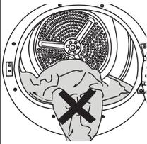
Stellen Sie sicher, dass sich keine Wäsche an der Gerätetür eingeklemmt ist. Schließen Sie die Gerätetür nicht mit Gewalt.
