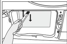
**i** Sie können von Hand reinigen, sofern Sie Schutzhandschuhe tragen. Versuchen Sie nicht, mit bloßen Händen zu reinigen. Die Kondensatorlamellen können Ihre Hände verletzen. Die Reinigung von links nach rechts kann die Kondensatorlamellen beschädigen. Dies kann zu Trocknungsproblemen führen.
