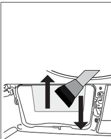
Reinigen Sie die Faser auf der Metalloberfläche des Kondensators mit einem feuchten Tuch oder der Bürste am Luftleitblech nach oben und unten. Reinigen Sie nicht von links nach rechts, da dies die Metallplatten des Kondensators beschädigen kann. Sie können einen Staubsauger mit einer Bürste zum Reinigen verwenden. Wenn der Staubsauger keine Bürste hat, wird nicht empfohlen, ihn für die Kondensatorreinigung zu verwenden.
