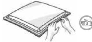
Installez la table de cuisson dans l'ouverture du plan de cuisson dont les dimensions correspondent à celles figurant dans le mode d'emploi.
