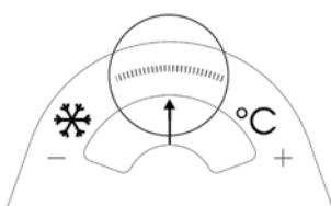
Lorsque l'aiguille est dans la zone centrale, la température est adaptée.
