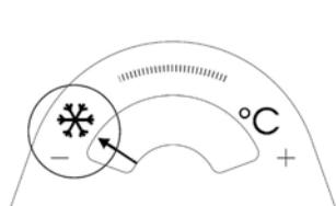
Lorsque l'aiguille est dans la zone gauche, il faut augmenter la température du compartiment réfrigérateur.
