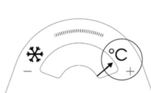
Lorsque l'aiguille est dans la zone de droite, il faut diminuer la température du compartiment réfrigérateur.
