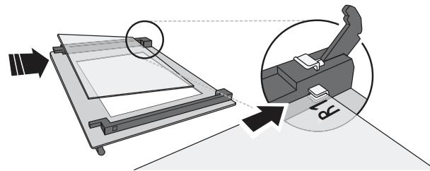
**4.** Replacez le bord supérieur : un déclic indique le positionnement correct. Assurez-vous que le joint est bien placé avant de replacer la porte.
